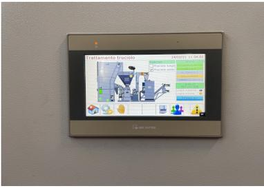
Les groupes de traitement COMPACT sont équipés d'un automate pour la surveillance continue des paramètres du cycle de traitement
