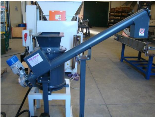
UTILISATION DU CONVOYEUR À VIS SANS FIN
