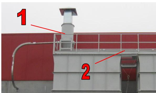
**ESEMPIO:** Nel caso di doppio o triplo silo, l'arrivo del truciolo è gestito da un separatore ciclonico [1], che carica un canale trasportatore a palette [2] per la redistribuzione del truciolo nei vari silo.
