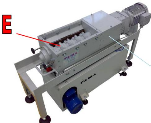
**EXEMPLE :** Si les copeaux sont longs ou emmêlés, il faut associer le GSM à un broyeur modèle TAL, pour broyer les copeaux et les rendre transportable par voie pneumatique.
