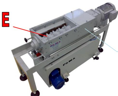
**ESEMPIO:** Nel caso in cui il truciolo sia lungo e matassoso, si combina al GSM un tritatore modello TAL, per macinare il truciolo e renderlo trasportabile per via pneumatica.
