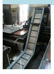
Les canaux peuvent être simples ou doubles selon le matériau de composition des copeaux (unique ou double). Dans ce cas, on a réalisé un canal à palettes pour le laiton et un canal à volets pour l'acier.
