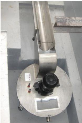
**BEISPIEL:** Öl- und Späneauffangbehälter an Bord der Maschine. In diesem Fall befördern Kanäle die Späne dank des Schubs der Emulsion in den Tank. Von hier aus schickt die Pumpe alles in den Behandlungstank.
