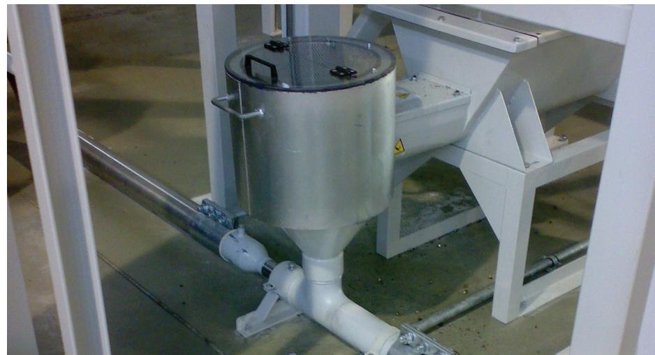
Dans le cas d'un silo unique, l'entrée est directe. Dans le cas de silos doubles ou triples, l'arrivée des copeaux est gérée par un séparateur cyclonique, qui alimente un convoyeur à palettes pour la redistribution des copeaux dans les différents silos.
