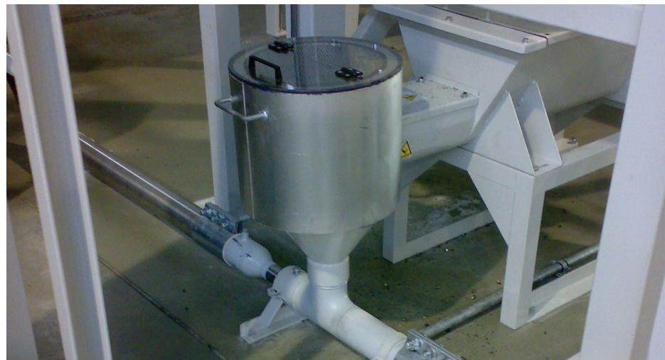
Bei einem Einzelsilo erfolgt der Einlass direkt. Bei Doppel- oder Dreifachsilos wird die Späneankunft über einen Zylkonabscheider gesteuert, der einen Kettenkratzerförderer zur Umverteilung der Späne in die verschiedenen Silos beschickt.
