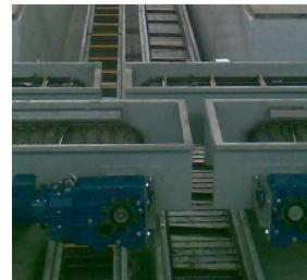
Les canaux peuvent être simples ou doubles selon le matériau de composition des copeaux (unique ou double). Dans ce cas, on a réalisé un canal à palettes pour le laiton et un canal à volets pour l'acier.
