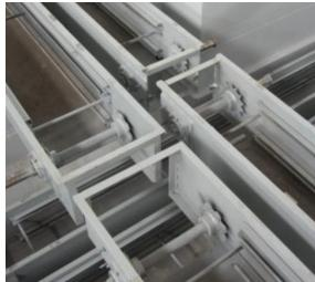
Die Richtungsänderungen können durch Schwerkraft oder durch direkten Schnittpunkt für Öl mit Entenschnabel für den festen Teil erfolgen.
