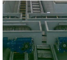
Die Kanäle können einfach oder doppelt für Mono- oder Bi-Material sein. In diesem Fall wurden ein Schaufelkanal für Messing und ein Metallkettenkanal für Stahl geschaffen.
