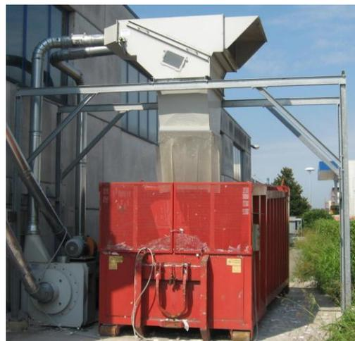
**Sistema automatico di deviazione scarico scarti su container di riserva** per evitare fermate di produzione quando il container è pieno.
