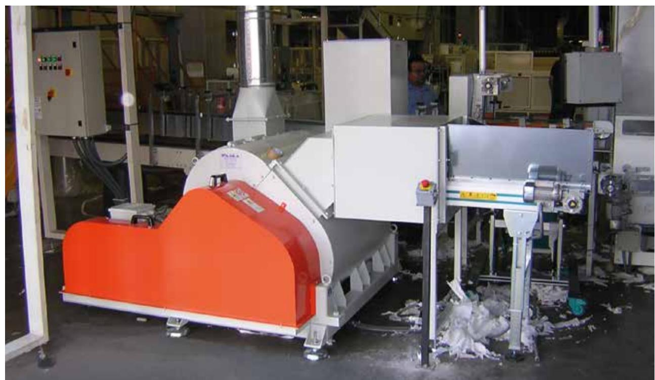
**Triturazione scarti da troncatore** - Log saw scraps shredding - Zerkleinern von Rollenschneiderabfällen
