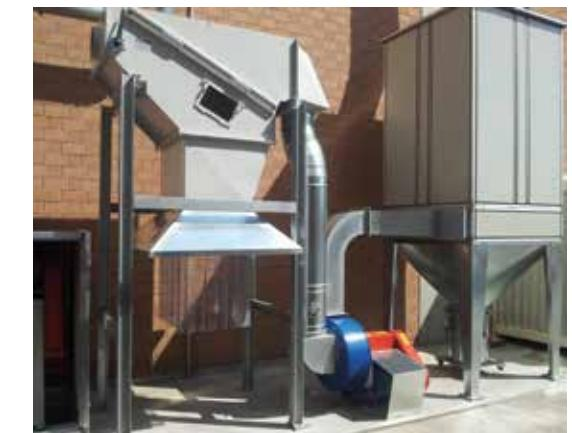
Il separatore a griglia “PSC” è un organo statico studiato e progettato per la separazione degli scarti di carta, cartone ed alluminio dall'aria, negli impianti di trasporto pneumatico degli stessi.
