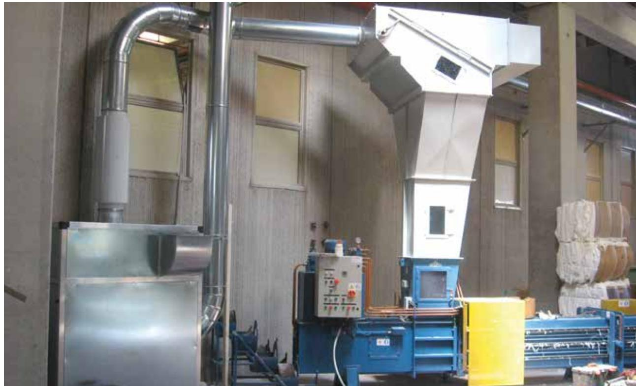
**Sistema centralizzato di aspirazione rifiuti con scarico in pressa imballatrice** - Centralised scrap extraction system with unloading into bale presses - Zentralisiertes System zur Absaugung von Produktionsrückständen mit Auswurf in eine Ballenpresse
