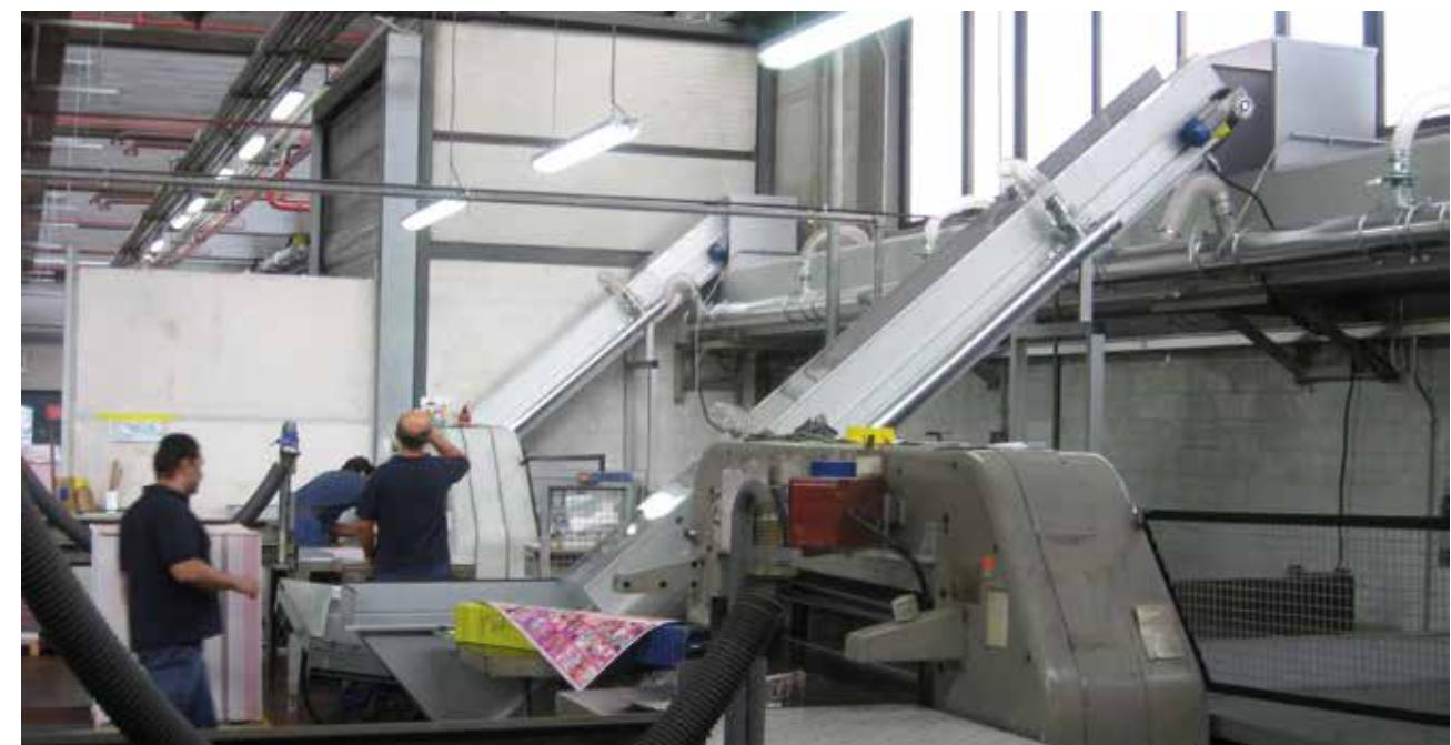
**Evacuazione centralizzata scarti con nastri trasportatori** - Centralised paper scrap evacuation with conveyor belts - Zentralisierte Entfernung der Abfälle mit Förderbändern
