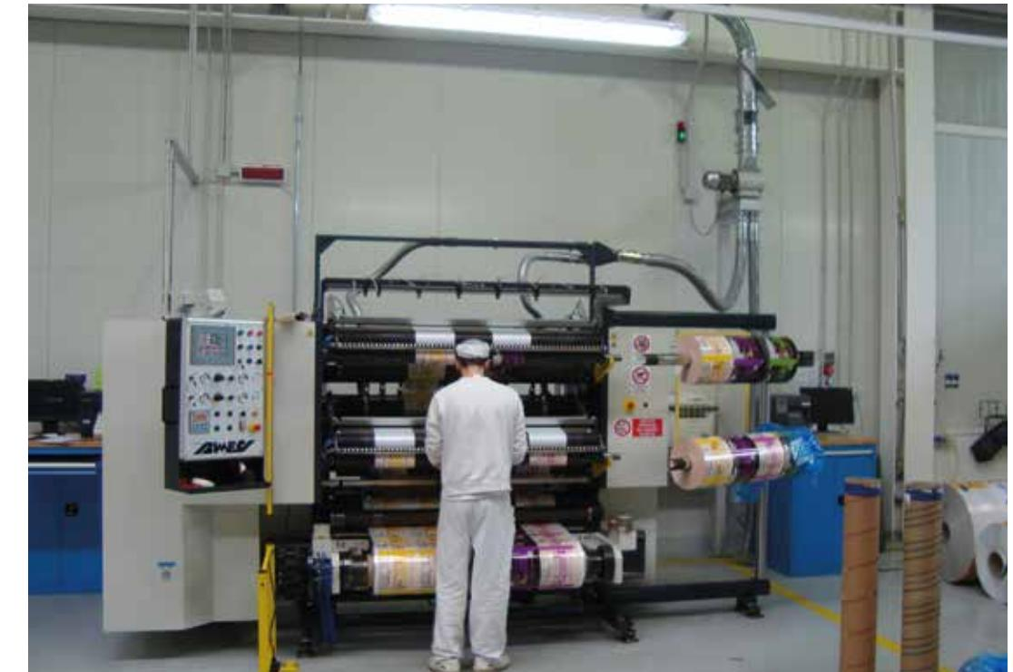
**Calata di aspirazione con cutter trita rifiuti** - Vertical extraction duct with trim cutter
